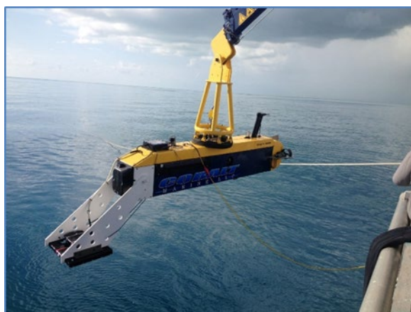
HAUV Dolores with Gen-1 EM array
